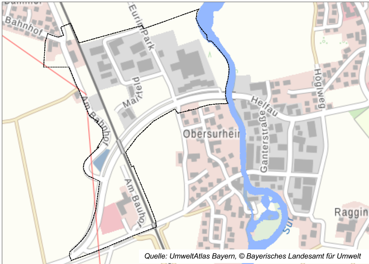
Abbildung 5: Darstellung der Gefahrenfläche für HQ 100 (blau) und des Änderungsbereichs; o. M.
